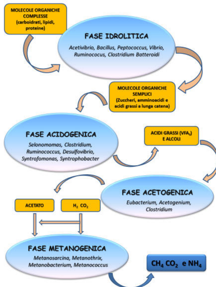
Fig 6: Gruppi batterici coinvolti nel processo anaerobico MANUALE APAT – DIGESTIONE ANAEROBICA DELLA FRAZIONE ORGANICA DA RIFIUTI
